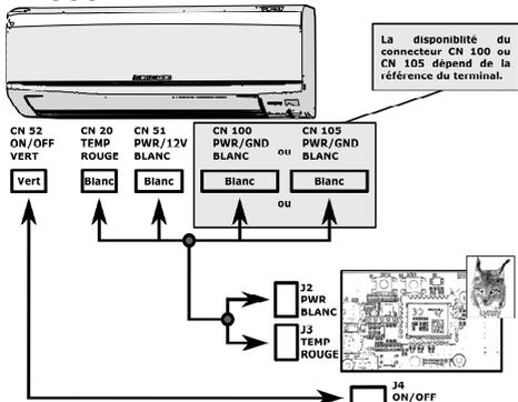
**NOTE :** Débrancher la sonde interne du connecteur CN 20 pour raccordement du signal LYNXY.
